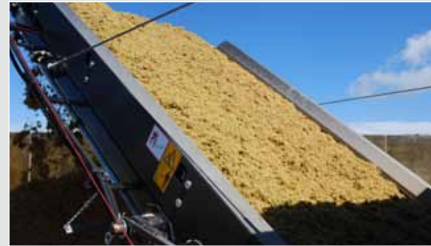
Maissilage rechts vor, links nach der Aufbereitung mit dem Doppstadt AK 430
